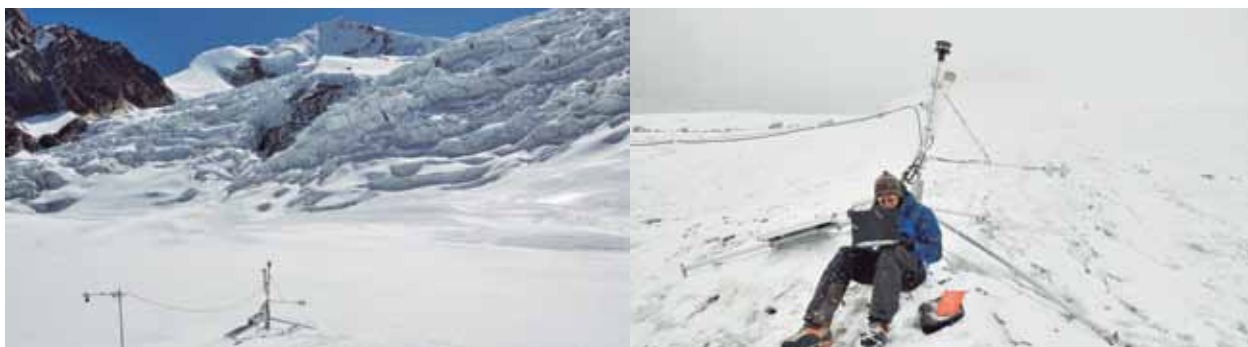
Estaciones móviles (tipo « SAMA ») colocadas sobre el glaciar, en la zona de ablación, a una altura similar a las estaciones fijas, Zongo. Fotos B.Francou
