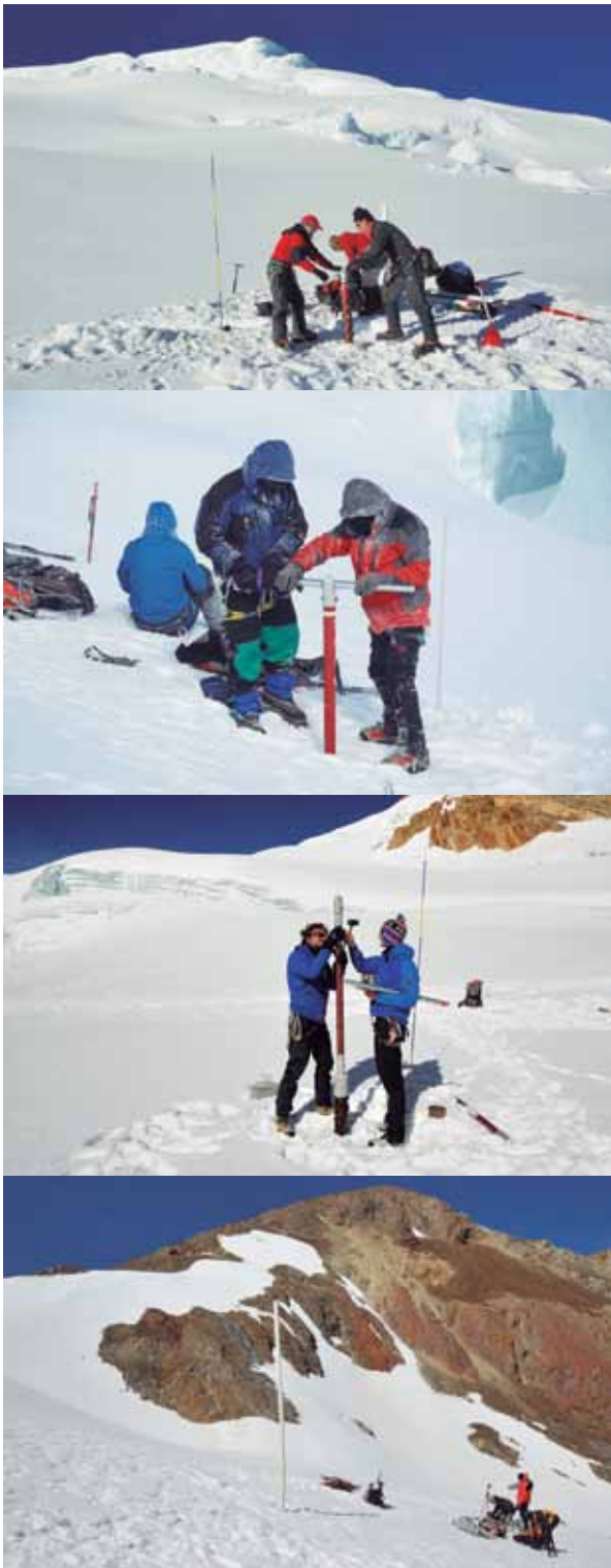
Medición de la acumulación neta de nieve en las partes altas de los glaciares monitoreados para el balance de masa. Zona de acumulación del glaciar 15a del Antisana (5400 m: fotos 1 y 2), del glaciar de Zongo (6000 m: foto 3) y del glaciar del Charquini (5200 m: foto 4). Este tipo de medición se realiza una (o dos veces) al año al final del año hidrológico (y de la temporada de acumulación), y permite estimar el balance de masa en la parte alta (zona de acumulación) del glaciar. Fotos B.Francou
