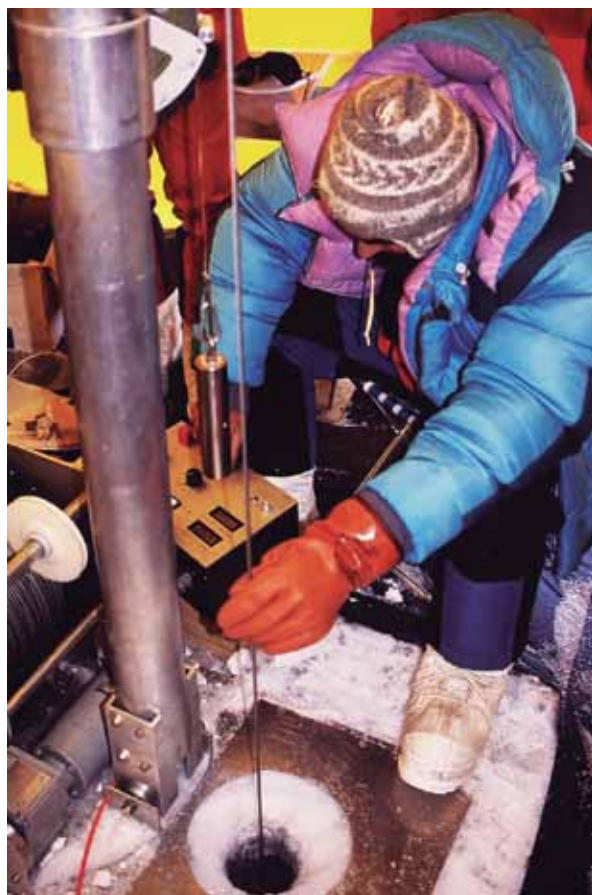
Perforación hasta el bedrock (139 m) del col del Illimani (6340 m) en julio 1999, organizada por el IRD y el Paul Scherer Institute (Suiza), que requiso una permanencia de 17 días sobre esta montaña. Además de ofrecer un archivo casi completo del clima de ~18 000 años, esta perforación puso en evidencia un calentamiento de \sim 1^{\circ}\text{C} durante el siglo 20 a esta altura. Foto B.Francou
