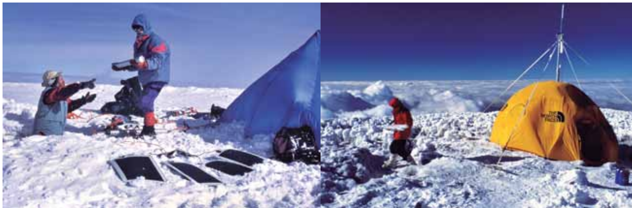
Perforación test en 1999 en la cumbre Veintimilla del Chimborazo (6230 m) para evaluar la calidad del hielo con intención de hacer luego una perforación profunda. Este tipo de prueba es necesaria para analizar el archivo climático que contiene (izquierda). Perforación al bedrock en 2000, desgraciadamente perturbada por la erupción del Tungurahua (derecha). Los testigos son cortados en cilindros de ~70 cm y almacenados en la cumbre, antes de ser descendidos al pie de la montaña para ser conservados en un camión refrigerado. Fotos B.Francou
