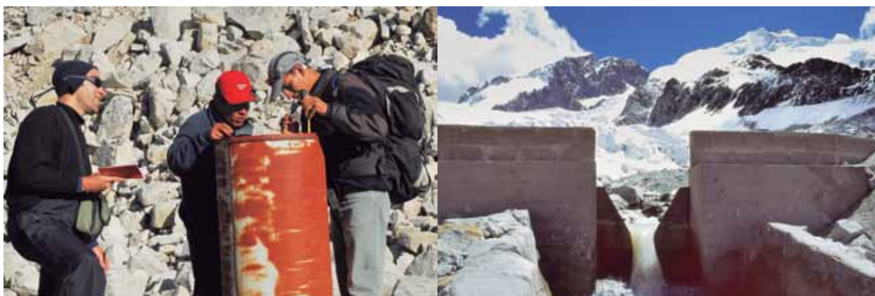
Estimación del total de precipitación acumulada a partir de una medición directa (izquierda). Este de tipo de pluviómetro totalizador, poco costoso, existe en toda la red andina. Ofrece estimaciones de la precipitación bastante confiables, particularmente cuando la mayor parte cae en forma sólida. Generalmente las lecturas son mensuales. Vertedero ubicado sobre el torrente del glaciar de Zongo (centro) a poca distancia del frente. Fotos B.Francou
