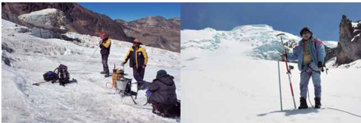
Medición de la ablación a partir de balizas de balance/velocidad. La instalación de este tipo de balisa requiere una sonda al vapor para perforar un hueco de una pulgada de diámetro y de 10-12 metros de profundidad. Las balizas son constituidas de tubos de PVC de 2 m de longitud. Se introducen cinco a seis de esos tubos en cada hueco. La medición a tiempo fijo de la emergencia de estas balizas, dispuestas en red en la zona de ablación del glaciar, ofrece la posibilidad de estimar el balance de masa de superficie en esta zona. El desplazamiento de la balisa medido con un DGPS proporciona una estimación de la velocidad superficial del hielo. Fotos B.Francou
