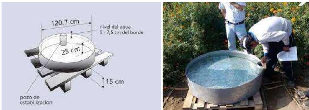
*Ilustración 4. Tanque de evaporación Clase "A"*
